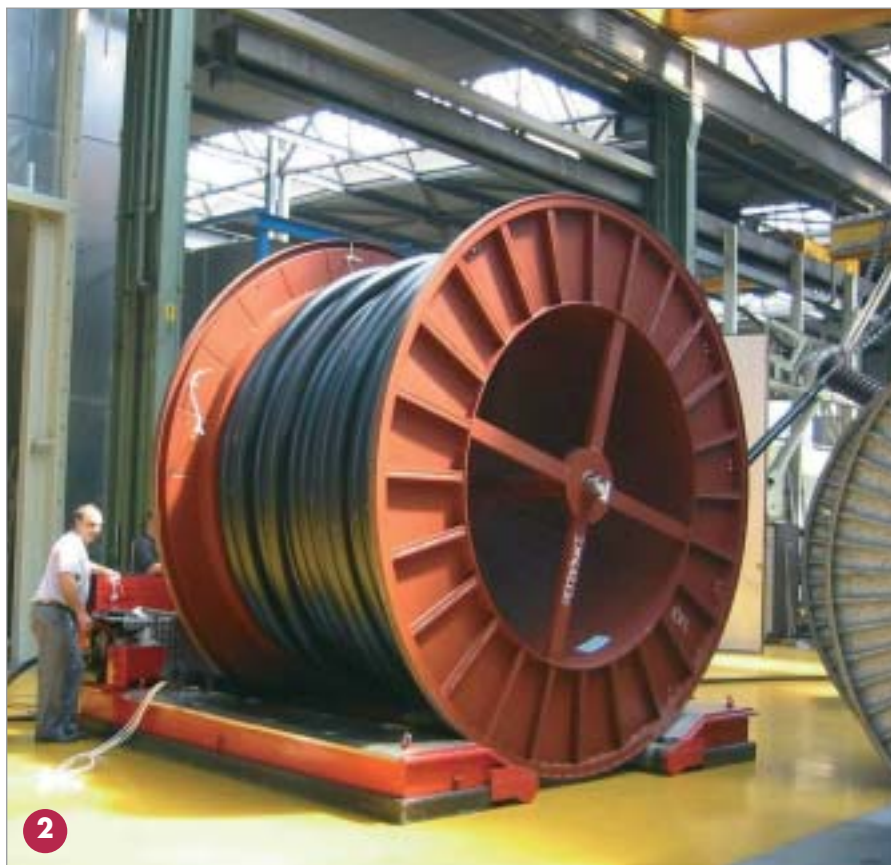
2 Sistema de colchonetas de aire con un rodillo de cables
