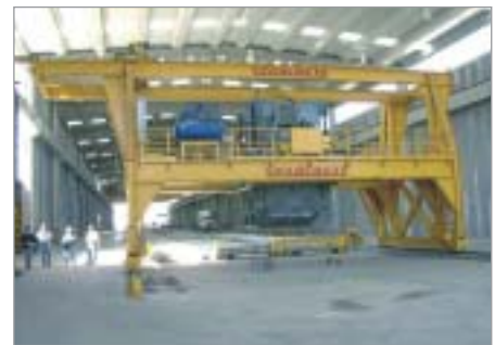
El sistema tipo puente (GT) de Spancrete en las nuevas instalaciones de ITISA de la Ciudad de México
