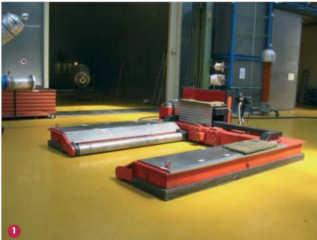
Sistema de colchonetas de aire sin carga
