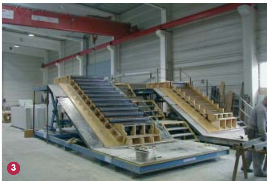
3 Rampa de encofrado apoyada sobre un sistema de colchonetas de aire
